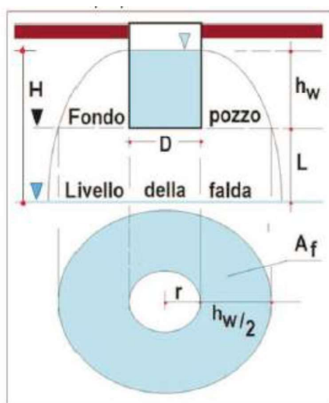
Schema di pozzo d'infiltrazione secondo F. Sieker
